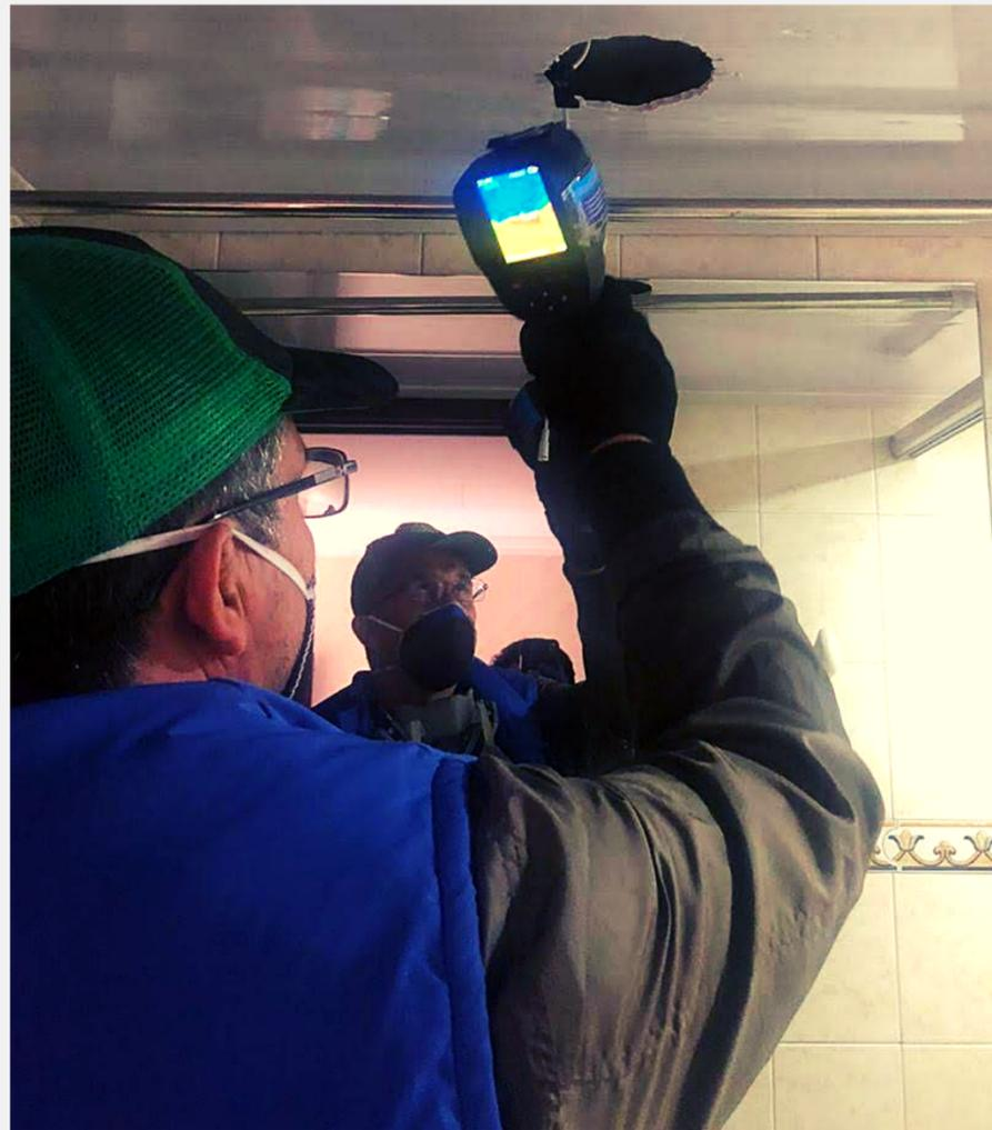
La cámara termográfica es un detector de radiación, que capta la radiación infrarroja emitida por los objetos, de manera que dicha radiación será leída e interpretada por la cámara.
